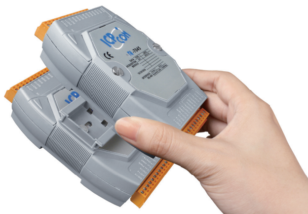
Стыковочный монтаж друг на друга
