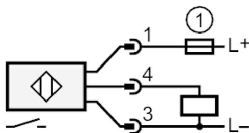
1 = Плавкий предохранитель
