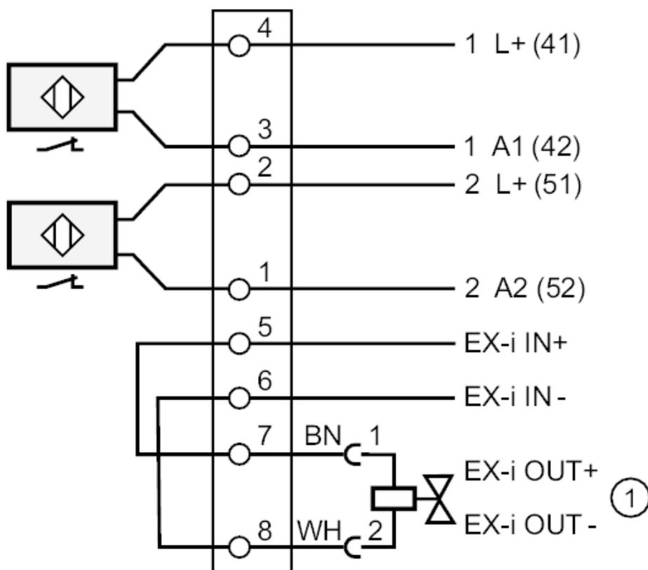
1 выход для электромагнитного клапана
