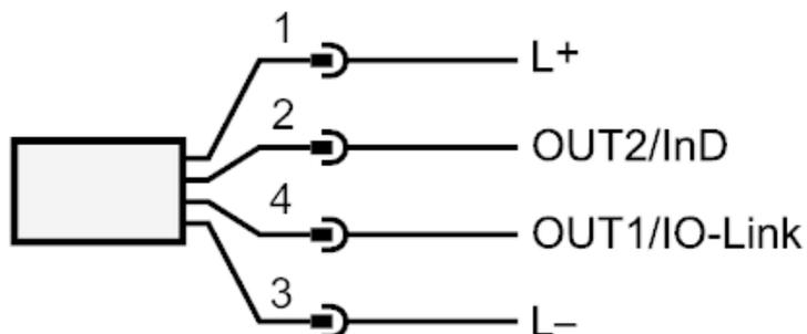
OUT1/IO-Link: Коммутационный выход Контроль моментального расхода
